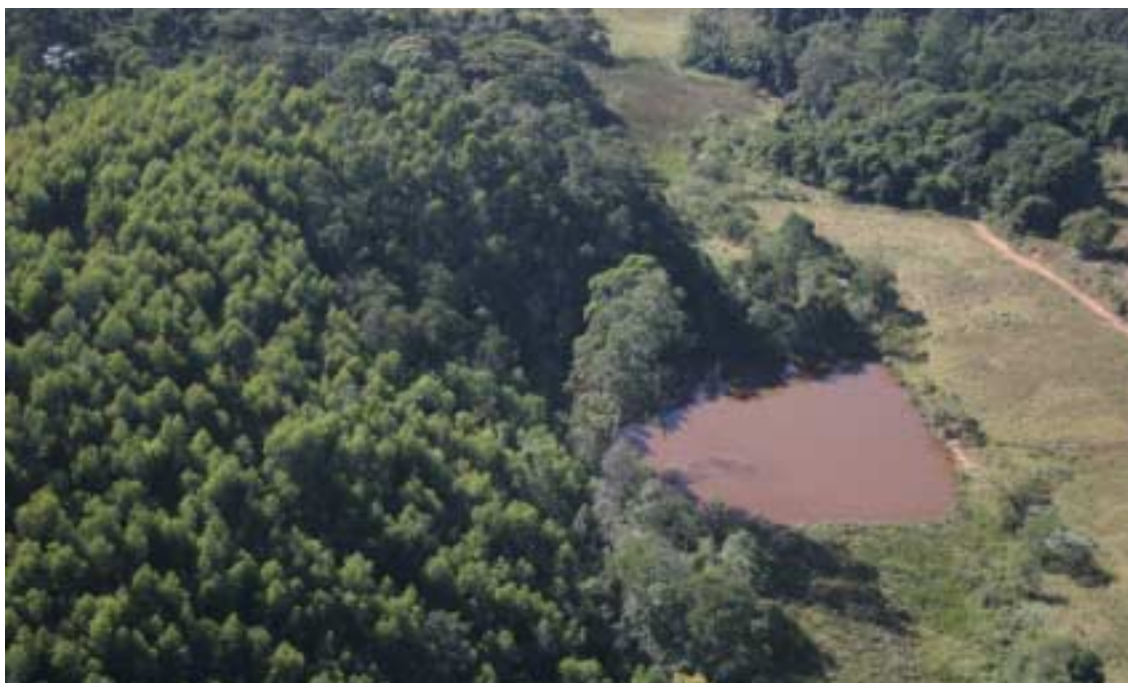
Figura 124: Lago L8 assoreado, situado no quadrante NW da ADA, com com acúmulo de sedimentos para montante.
