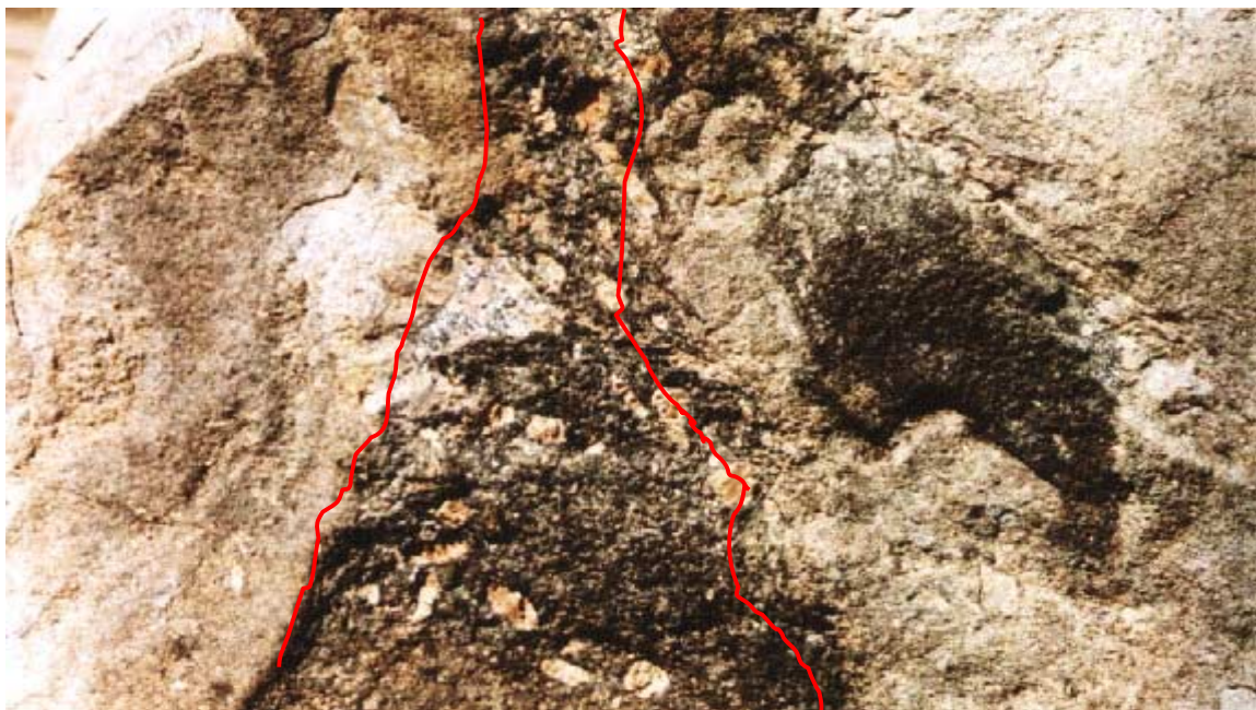
Figura 101: Granito gnaíse com textura porfirítica encaixado no gnaíse regional
