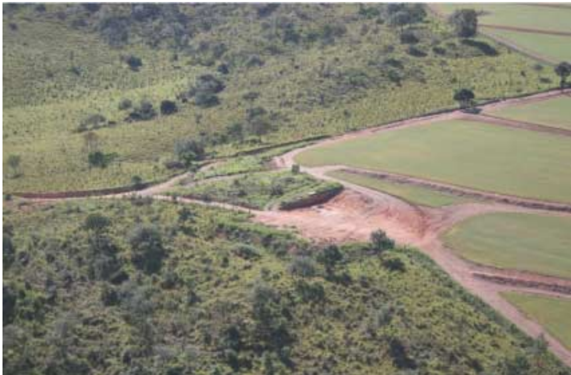
Figura 114: Observa-se abertura de vias de acesso com exposição de solo e saprolito, induzindo a instalação de processos erosivos
