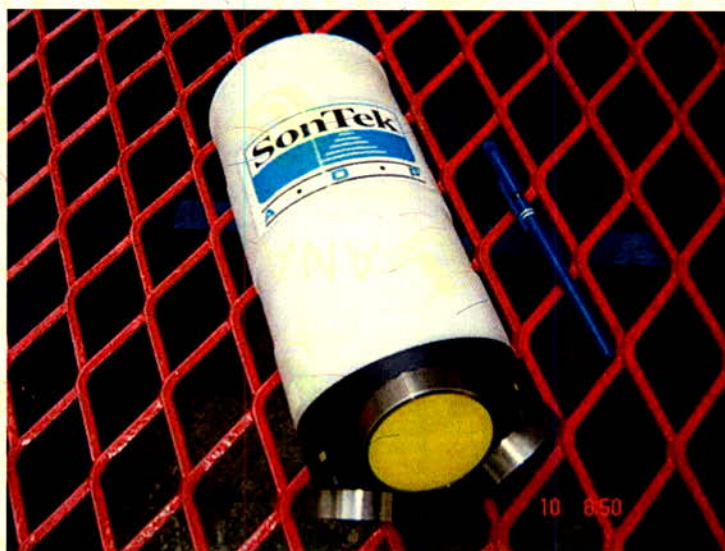
Figura 96. Perfilador Acústico de Corrente por Efeito Doppler ou ADCP (Foto: Luis Altivo Carvalho Alvim).
