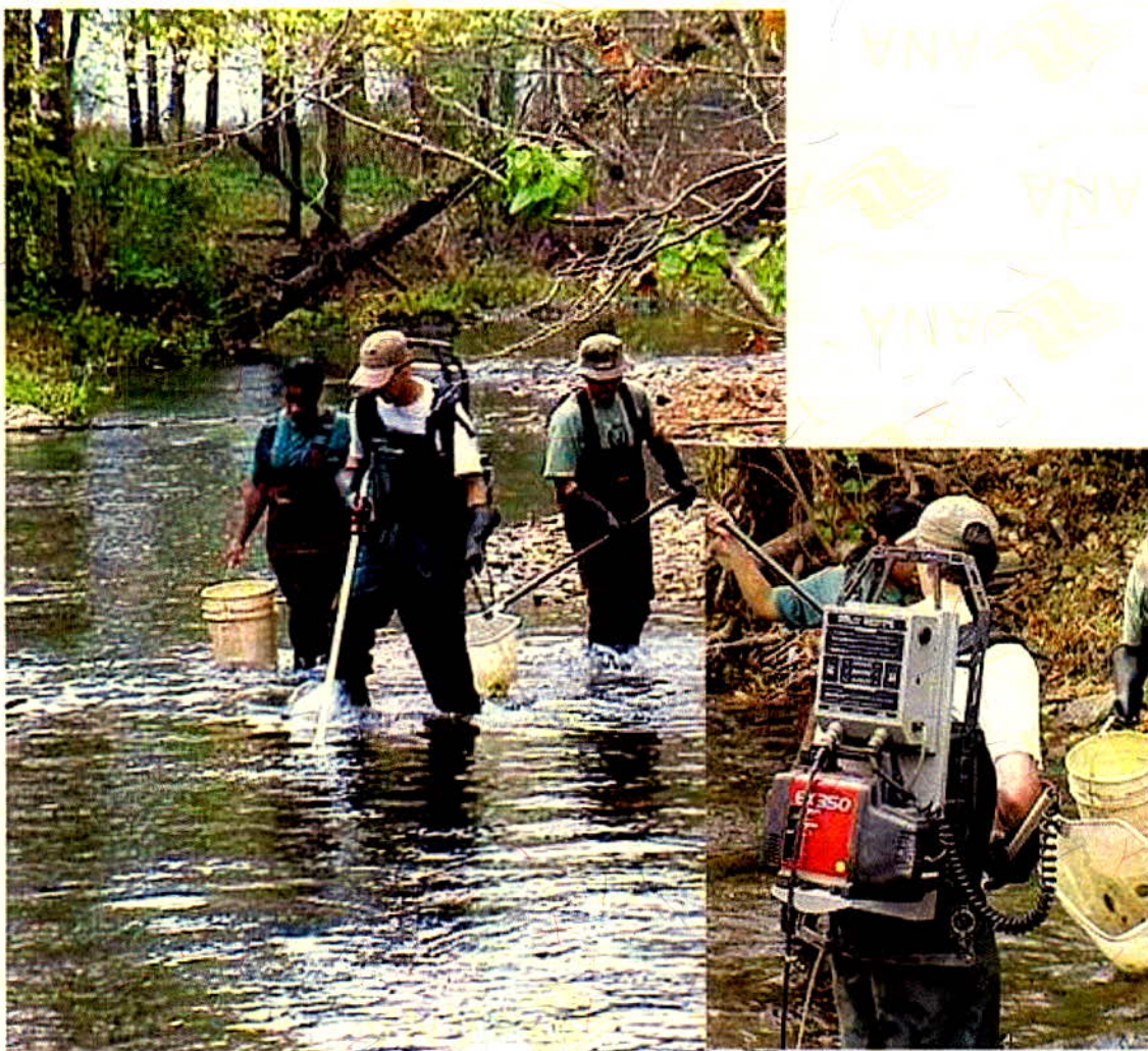
Figura 57. Pesca elétrica com aparelhagem do tipo mível (mochila). Foto: American Fisheries Society (usado com permissão)
