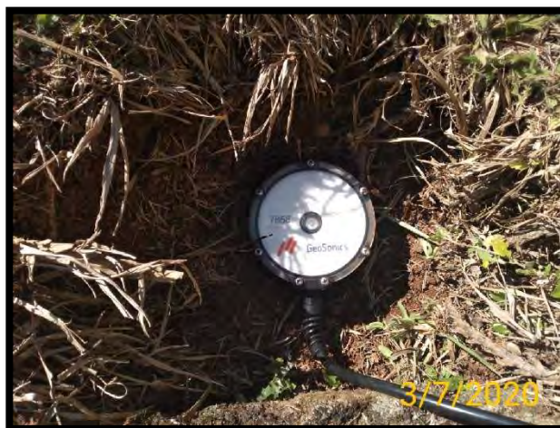
Fotos 3.3 – Instalação do Geofone
