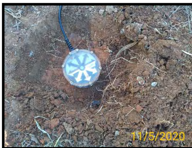
Fotos 3.3 – Instalação do Geofone
