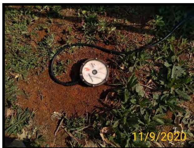
Fotos 3.3 – Instalação do Geofone
