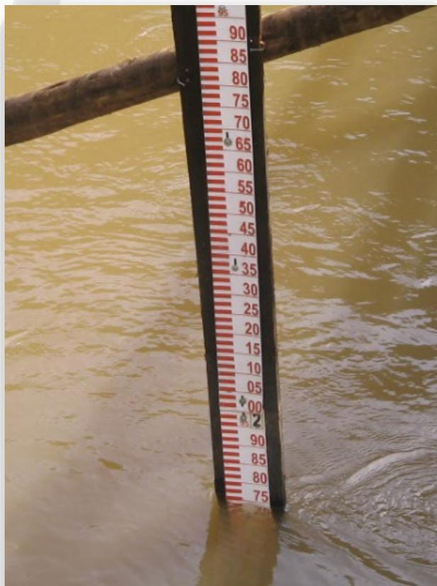
**Figura 184.** Exemplo de Régua Linimétrica utilizada para medição de sedimentos.
