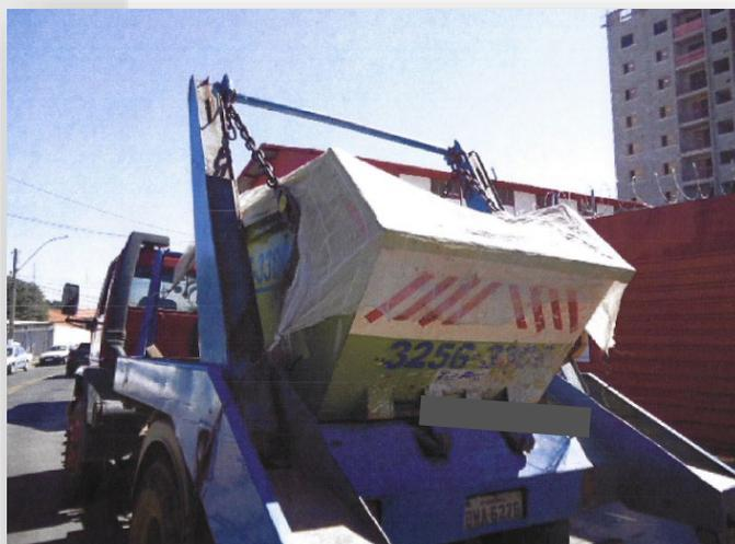
**Figura 181.** Exemplos de “lonamento” em caçamba de entulho e caminhão, para prevenção de poluição difusa.
