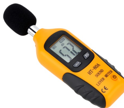
Aparelho de medição de ruído
